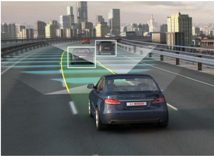
Նկ. 2 Ավտոմոբիլի ինքնավար արտակարգ արգելակումը վթարային իրավիճակում
